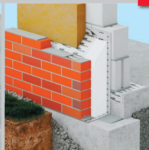
Im zweischaligen Mauerwerk auf Streifenfundament
