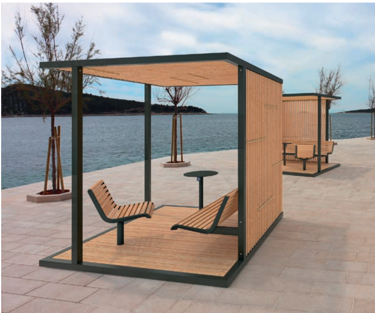
Pavillon CUBY MEET zum Aufdübeln bei +/- 0 mm, Dachbreite x Dachtiefe 2200 mm x 2200 mm, Dach und Wandelemente aus Holzlamellen, Stahlkonstruktion in RAL 7016 anthrazitgrau, Sitzbänke und Drehsitz mit Robinienholzbelattung sowie Tisch in RAL 7016 anthrazitgrau gegen Mehrpreis
