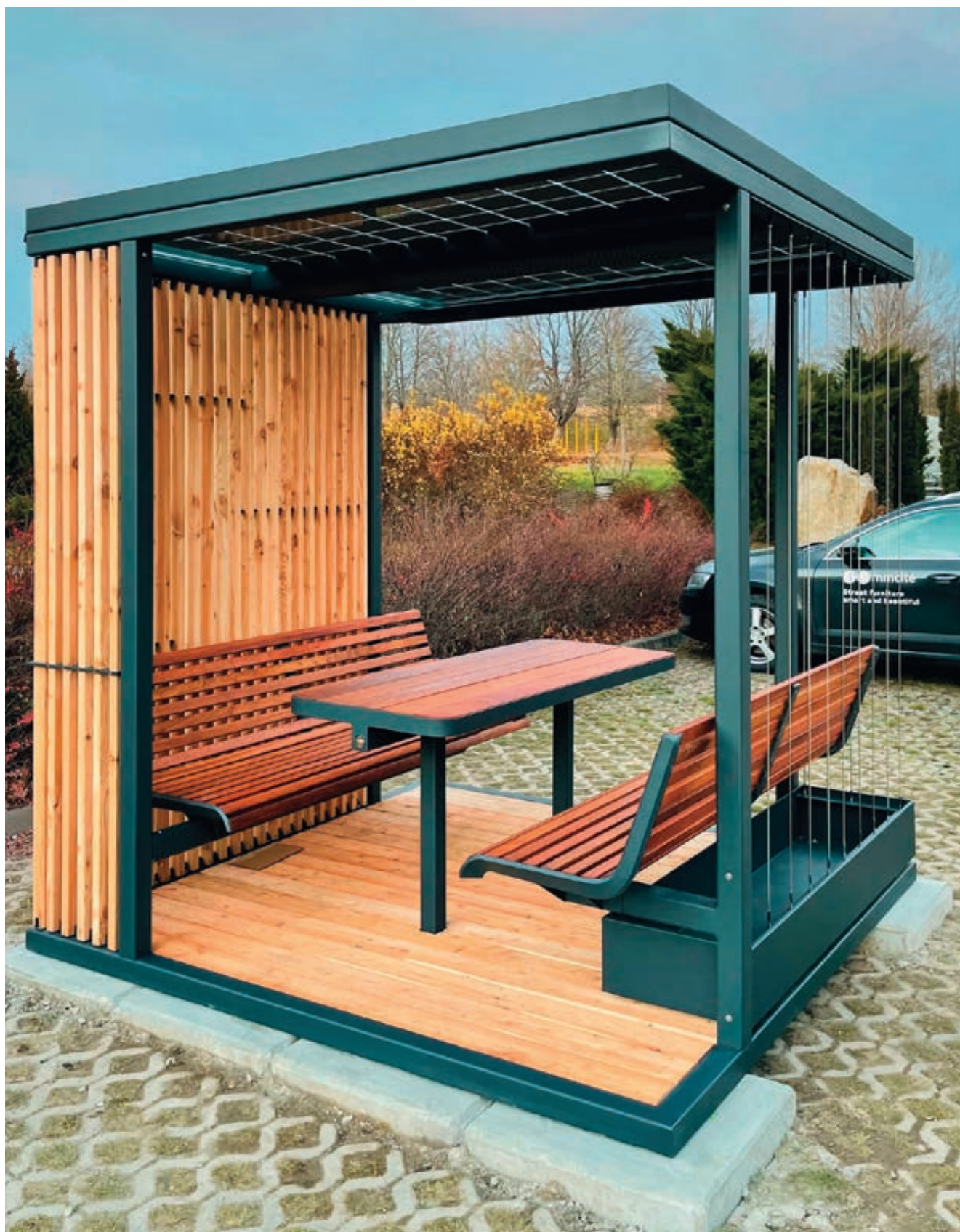
Pavillon CUBY SNACK zum Aufdübeln bei +/- 0 mm, Dachbreite x Dachtiefe 2200 mm x 2200 mm, Dacheindeckung aus Solarpaneelen, Wandelemente aus Holzlamellen bzw. mit Stahlseilen als Rankhilfe inklusive Pflanzbehälter (auftragsbezogene Anpassung), Stahlkonstruktion in RAL 9016 anthrazitgrau, Sitzbänke und Tisch mit Jatobaholzbelattung gegen Mehrpreis
