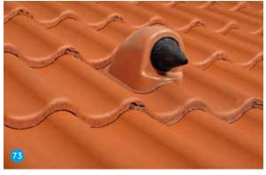
Gummimanschette abschneiden, Durchmesser ca. 5 mm weniger als Durchmesser Solarleitung und auf Solardurchgang F<sup>+</sup> aufstecken.
