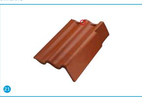
• Giebelstein  $F^+$  mit einer korrosionsgeschützten Senkkopfschraube  $4,5 \times 80$  mm im Bereich der Mittelkrempe befestigen, ohne Dichtscheibe, um Aufsperren der Dach-steine zu vermeiden.
