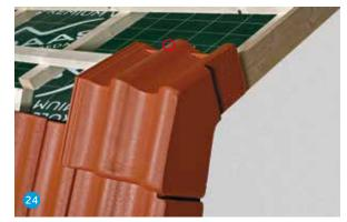
Mansardstein F<sup>+</sup>/Mansard-Giebelstein F<sup>+</sup> mit einer korrosionsgeschützten Senkkopfschraube 4,5 x 80 mm im Bereich der Mittelkrempe befestigen, ohne Dichtscheibe, um Aufsperren der Dachsteine zu vermeiden.
