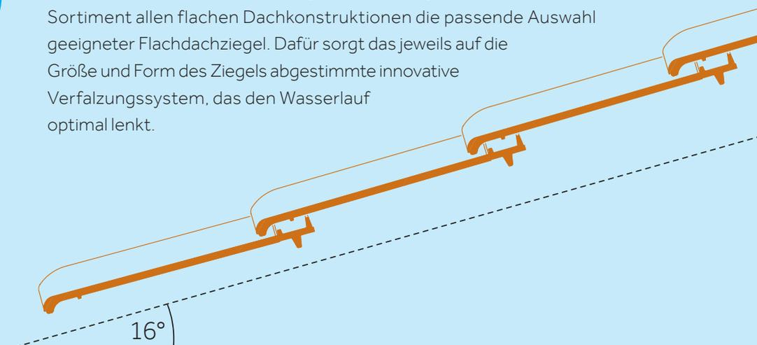
\* Aufgrund der nachgewiesenen besseren Regeneintragssicherheit geringere Regeldachneigung als in den ZVDH Fachregeln Dachziegel/Dachsteine angegeben. Zuordnung der Zusatzmaßnahmen gemäß Braas Verlegeanleitung Dachziegel.
