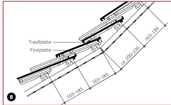
Die Dachdeckung der unteren Dachfläche endet mit Firstplatten. Die darüber liegende Dachdeckung beginnt wie an der Traufe mit Traufplatten.
