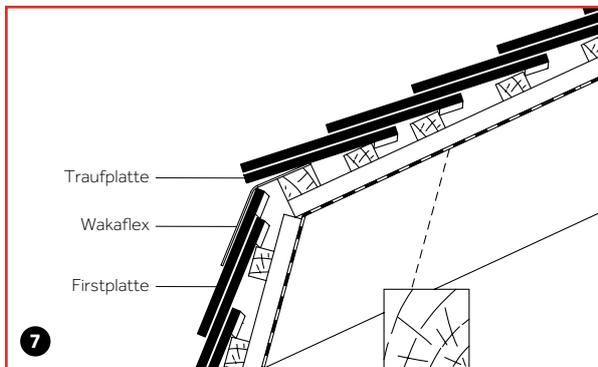
Bei der Ausbildung des Mansardknicks mit Opal Biberschwanzziegeln erfolgt der Abschluss der unteren Dachfläche mit Firstplatten oder einem Kronengebinde. Die Dachdeckung der oberen Dachfläche beginnt wie an der Traufe mit Traufplatten. Je nach örtlichen Gegebenheiten kann der Übergang der Dachflächen z. B. mit Wakaflex hergestellt werden. Die Lattmaße für die letzte untere und erste obere Dachziegelreihe sind individuell auf das Detail abzustimmen.
