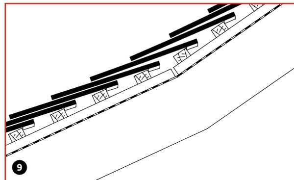
Bei geringen Dachneigungsunterschieden von unterer und oberer Dachfläche können die Biberschwanzziegel durchgedeckt werden. Der Dachknick kann z. B. durch das Aufdoppeln der Traglatte im Dachknick abgeschwächt werden.
