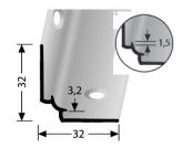
Bezeichnung: Treppeninnenwinkel aus Aluminium, doppelt versenkt
