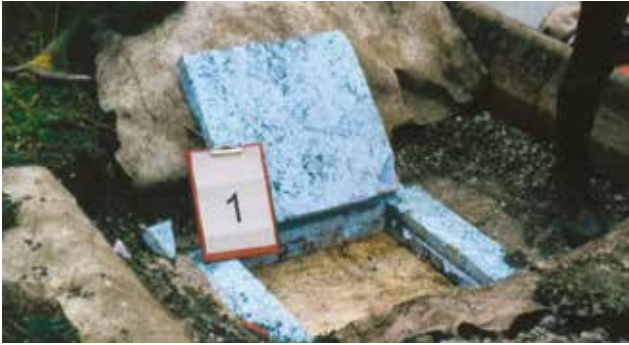
Abb.48: Entnahme der blauen XPS Platte nach 12 Jahren Einbauzeit
