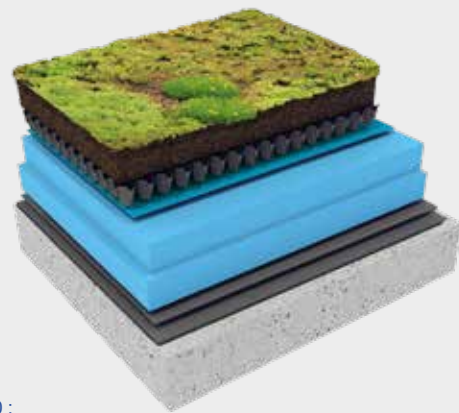
Abb. 30 : Extensiv begrüntes Umkehrdach (einlagige Verlegung)
