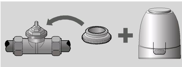
Die Ventilanpassung erfolgt über einen Ventiladapter der in diversen Ausführungen für die gängigsten Ventilunterteile und Heizkreisverteiler lieferbar ist. (bei Bestellung berücksichtigen).
