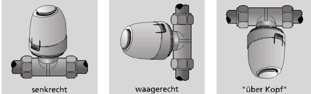
Der Antrieb ist bevorzugt in senkrechter und waagerechter Montagelage einzubauen. Bei „über Kopf“ –Montage können spezielle Umstände (z.B. Schmutzwasser) die Lebensdauer reduzieren.
