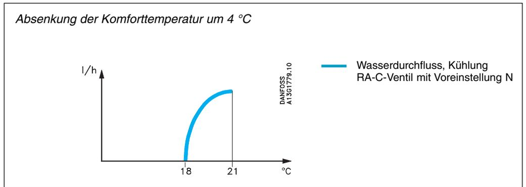
Der Regler wird für eine Absenkung der Komforttemperatur von 22 °C um 4 °C auf etwa 18 °C bei Xp = 0 K gedreht.
