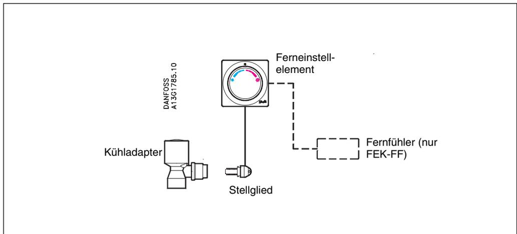
Die FEK-Fühler werden mit RA-C-Ventilen eingesetzt.
