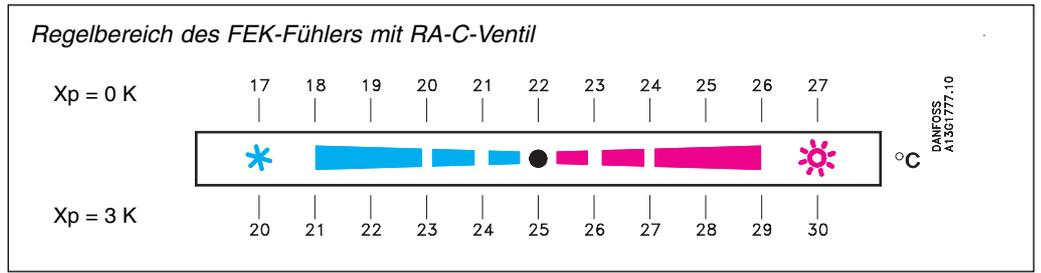
Bei einer Einstellung im blauen Temperaturbereich liegt der Einstellpunkt des Kühlkreises unterhalb der Komforttemperatur, d.h. das Ventil öffnet bei einer unter der Komforttemperatur von etwa 22 °C liegenden Temperatur. Bei einer Einstellung im roten Temperaturbereich liegt der Einstellpunkt des Kühlkreises oberhalb der Komforttemperatur. Das Ventil im Kühlkreis öffnet bei einer über der Komforttemperatur von etwa 22 °C liegenden Raumtemperatur.
