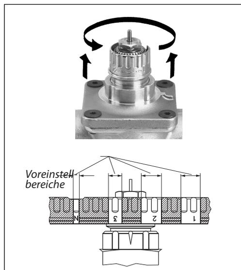
Bei voreinstellbaren Danfoss Ventilgehäusen lassen sich die dimensionierten Einstellwerte ohne Werkzeug einfach und exakt einstellen:
