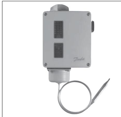
Ein Thermostat ist ein temperaturgesteuerter Wechselschalter, dessen Kontaktstellung von der Temperatur des Fühlers und dem an der Skala eingestellten Sollwert abhängig ist. Die RT-Serie umfasst Thermostate für allgemeine Verwendung im industriellen und maritimen Bereich, u.a. Differenzthermostate, Thermostate für Neutralzonenregelung, sowie Thermostate mit Raum-, Kanal- und Kapillarrohrfühler.
