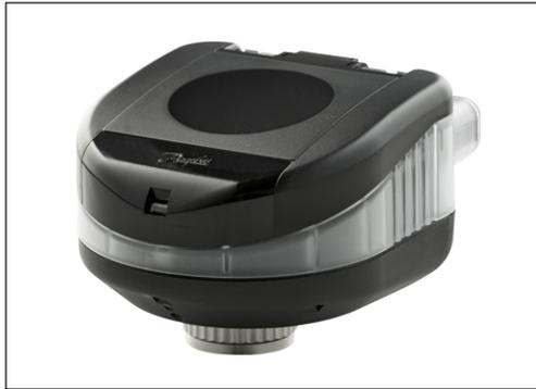
NovoCon® S ist ein multifunktionaler Hochgenauigkeits-Stellantrieb mit Feldbus. Er wurde speziell für die Verwendung mit druckunabhängigen Abgleich- und Regelventilen AB-QM in den Nennweiten von DN 10 bis DN 32 konzipiert. Der Durchfluss wird über ein druckunabhängiges Regelventil (PICV) AB-QM geregelt, um eine Überversorgung und einen damit verbundenen geringeren Wirkungsgrad am Kessel oder an der Kältemaschine zu vermeiden.
