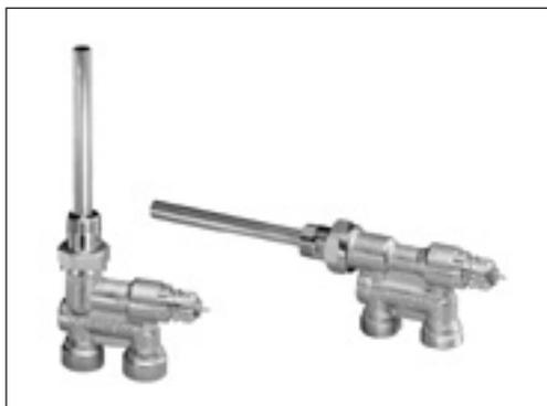
Im Einrohrbetrieb wird die umgewälzte konstante Wassermenge teils durch die Heizkörper und teils durch den eingebauten Bypass des Ventilgehäuses geleitet. Eine Auswahl von Klemmverbindern für Weichstahl-, Kupfer- und VPE-Kunststoffrohre ermöglicht eine rationelle Montage.
