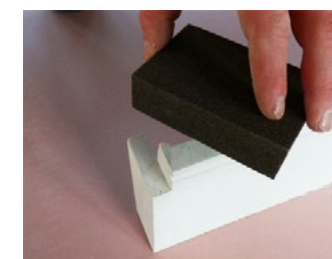
11. Zwischen den einzelnen Schichten etwa 24 Std. warten, bis sie hart werden. Bevor eine weitere Schicht des Zementkitts aufgetragen wird, muss die vorherige Schicht nachgeschliffen und angefeuchtet werden.
