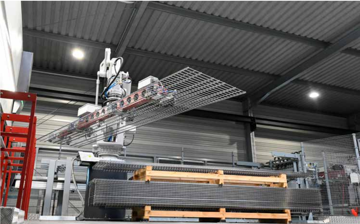
Automatisierte Entnahme der gefertigten Stahl-Gittermatten
