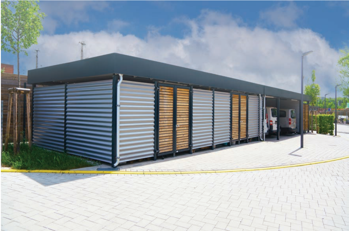
Müll- und Fahrradeinhausung mit Carportanlage , Tragkonstruktion nach RAL 7016 Anthrazit pulverbeschichtet, Seitenverkleidung Stahlwelle, Torfüllung Woodline 7 mm, Trapezblechdacheindeckung und Attika mit Gefälleausgleich.
