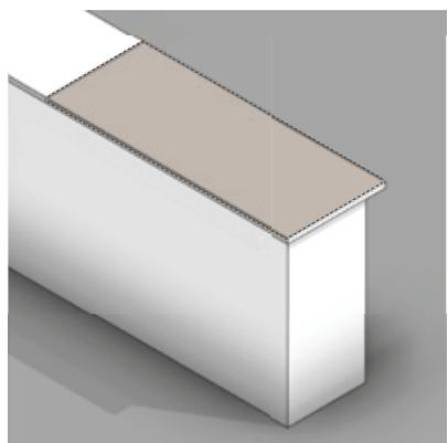
*Il coprimuretto riveste le parti superiori di muretti e soluzioni affini. Nella parte inferiore è dotato di una lavorazione rompigoccia: interrompe lo scorrenimento dell'acqua facendola cadere a terra e proteggendo così la struttura.*
