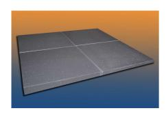
Zum Einsatz im Flachdachbereich hoch druckbelastbare Wärmedämmplatte aus expandiertem Polystyrol (EPS-Hartschaum) mit einer Wärmeleitfähigkeit  $\lambda$  = 0,032 W/(mK).
