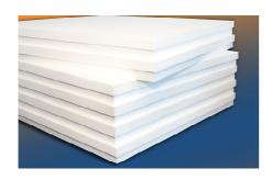
Zum Einsatz im Flachdachbereich eine hoch druckbelastbare Wärmedämmplatte aus expandiertem Polystyrol (EPS-Hartschaum) mit einer Wärmeleitfähigkeit  $\lambda$  = 0,035 W/(mK) und umlaufenden Stufenfalz zur Vermeidung von Wärmebrücken.
