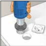
4. Aussparungen für Schalter und Steckdosen vor der Platten-Montage mit einer Lochsäge o.Ä. bohren und geeignete luftdichte Unterputzdosen verwenden.
