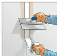
**7.** Um den Nahtbereich zu armieren, sollte eine Rissbinde in einer Spachtelmasse eingearbeitet werden.
