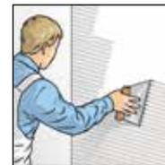
**2b.** Bei mittel bis grob strukturierten Untergründen ERFURT-Systemkleber SR 4 mit einem Zahnpachtel (B2 oder C3, je nach Untergrund) gleichmäßig quer zur Laufrichtung direkt auf die Wandfläche auftragen.
