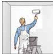
**2a.** Bei glatten bis leicht strukturierten Untergründen ERFURT-Systemkleber SR 2 mit einer langflorigen Walze bahnenweise satt auf den Untergrund aufrollen.
