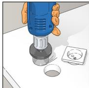
**4.** Löcher für Steckdosen vor der Plattenmontage mit einer Lochsäge bohren.
