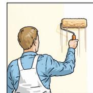
6. Dämmkeil mit Kleister grundieren.
