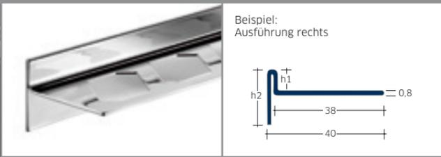
Für die perfekte Detaillösung an Gefälleflächen zum Anschluss an Böden bei Linienentwässerungen: der BLANKE AQUA-KEIL. Die Gefällekannte aus Edelstahl ist als rechte und linke Ausführung erhältlich.
