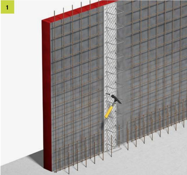
FERBOX® Rückbiegeanschluss lagegenau auf Schalung befestigen:
