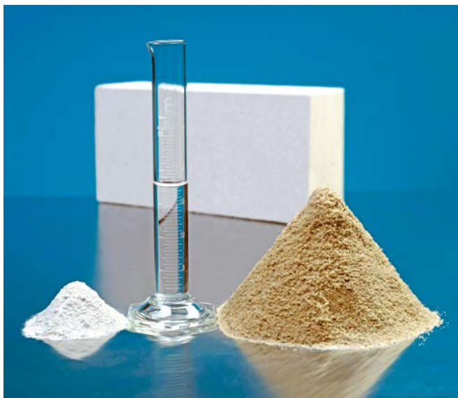
Bild 1 Die Rohstoffe: Kalk, Sand und Wasser
