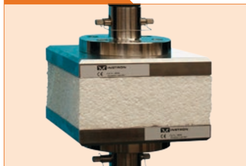
Prüfung der Druckspannung gemäß EN 826
