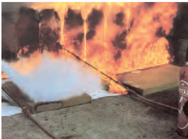
Schmelzende Dachbaustoffe (hier: Bitumen) stellen eine hohe Gefahr dar
