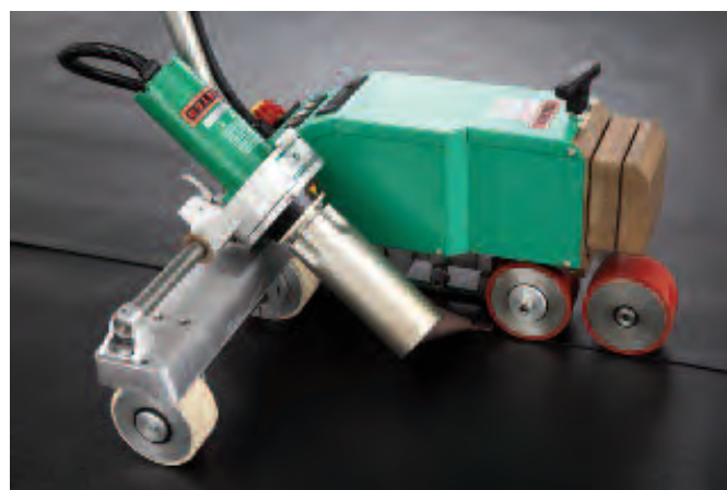
Sicheres Verschweißen von Kunststoffbahnen mit Heißluft
