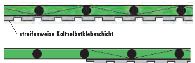
Schnelle und rationelle Verlegung, hier mit der WOLFIN GWSK
