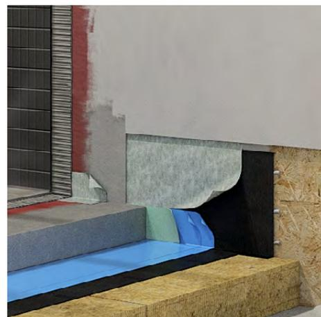
**6** Am Übergang zur Wand wird das Verbundblech mit dem 18 cm breiten Teroson TA Fleece überklebt. Hierbei handelt es sich um ein selbstklebendes, überputz- und überspachtelbares Butylband, an welches mit diversen mineralischen Materialien direkt angeschlossen werden kann.
