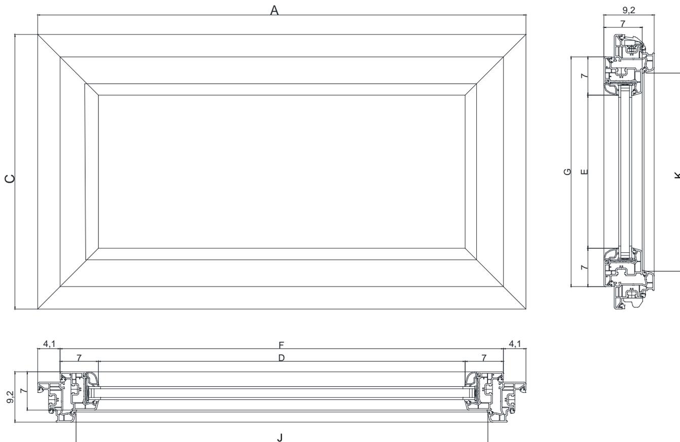
Querschnitt MEALUXIT (Maße in mm)
