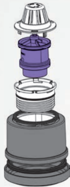
Set MEASTOP PRO Illustration des Aufbaus
