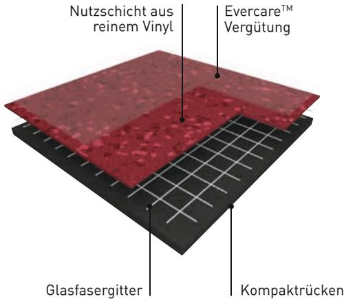
**PREMIUM COMPACT** ist ein elastischer heterogener Vinyl-Bodenbelag nach ISO 10582 (EN 649) mit einer farbigen, dessinierten, ungefüllten Nutzschicht (Nutzschichtdicke  $\geq 1,0$  mm) und Kompaktrücken. Dank seiner Verschleißfestigkeit und einer Glasfasergitter-Verstärkung zeichnet er sich durch eine besonders hohe Strapazierbarkeit für Objekte mit höchster Beanspruchung aus. Er verfügt über innovative, richtungsfreie Designs. Lieferbar in Bahnen (2 m breit).
