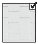
Zu den Wänden hin wird eine Fuge von 5 mm gelassen. Die lose Verlegung ist auf 150 m2 begrenzt. Größere Flächen müssen entsprechend aufgeteilt und jeweils zwei Fliesen übergreifend verklebt verlegt werden. Hierzu kann entweder ein extra breites doppelseitiges Klebeband oder ein anderer geeigneter Klebstoff verwendet werden.
