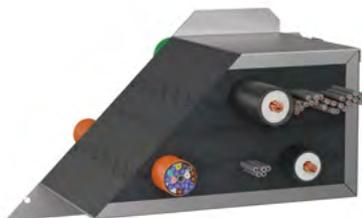
Die Akustikbox E ist anders als die Standardbox mit Waffelschaumstoff voll belegt. Das Blechgehäuse kann mit einem Spanverschluss bequem geöffnet werden. Die Schaumstofflagen in der Box können dann herausgenommen werden. Die Lagen bestehen aus eins zu eins ineinandergreifenden Noppenschaumstoffen. Der Schaumstoff kann zugeschnitten und z.B. an verlegte Kabeltrassen angepasst werden.
