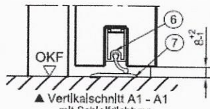
▲ Vertikalschnitt A1 - A1 mit Schleifdichtung
