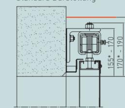
\* UK-Sturzdichtung ist bündig mit dem UK-Betonsturz
