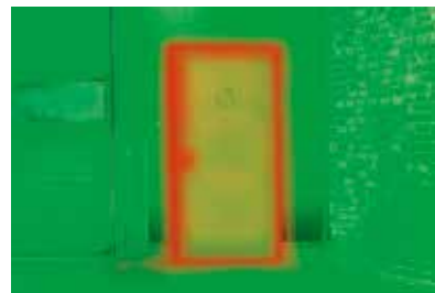
Sichtbarer Energieverlust ohne thermisch getrennte Tür
