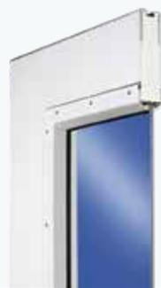
Doppelscheibe 18 mm, VSG 6 mm bzw. ISO-VSG 21 mm, mit Stahl-Glshalteleisten. Neu: Schlagregendichtigkeit Klasse 3
