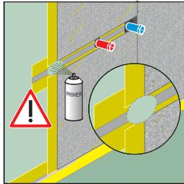
**D 7.** Den Bereich von Kellenschutz und Vlies der Dichtbahn mit Sprühprimer gesättigt auftragen.
