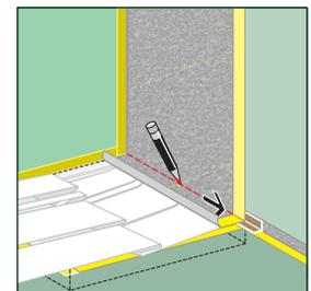
**C 10.** Dichtbahn entlang des Pappwinkels im Bereich Wand/Boden (Wanne) mit einem Stift markieren.
