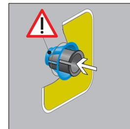
G 4. Mit der Einschubhülse den Manschettenkragen der Dichtmanschette über den Rohranschluss schieben. Der Manschettenkragen muss **mit Spannung** auf dem Wasseranschluss sitzen!
