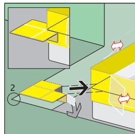
**A 13.** Flexible Dichtecke für Ecke 2 (Anbindung Boden/Boden). Schutzfolie vom Wannenkleber (schwarz) der Dichtecke abziehen, rückseitig an das Wannendichtband positionieren und andrücken. Schutzfolie des Wannendicht+ bandes wieder andrücken!
