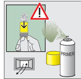
**A 4.** Wenn der Klebeversuch negativ ausfällt, kann der Sprühprimer herangezogen werden. Sprühprimer bei geöffnetem Fenster oder Tür im Abstand von 5-10 cm leicht aufsprühen. (Verarbeitungshinweise des Herstellers beachten!) **Neu! Handwerkerfreundliches Primern (10 min. Trocknungszeit).**
