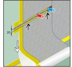
**D 5.** Den Rest der Dichtbahn **bei 20 mm unterhalb** der Mitte des Eckklebebandes ansetzen und bis zum Boden ankleben.
