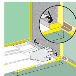
**C 9.** Dichtbahn mit der Hand gründlich in die Kelle eines **Pappwinkels** streichen.
