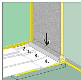
**C 8.** Alle Schutzfolien werden bis kurz über dem Eckklebeband abgezogen und die Dichtbahn angedrückt. **Schutzfolien unten im Übergang Wand/Boden noch nicht abziehen!**
