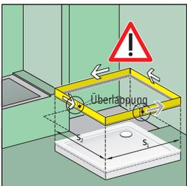
**A 10. Bodenebener Einbau / Überlappung nur auf Längsseite!** Duschwanne ausmessen (s1+s2) x2, **Wannendichtband** ansetzen und umlaufend ankleben. Falls eine Verlängerung erforderlich ist, kann das Wannendichtband auf den Längsseiten überlappend angesetzt werden.
