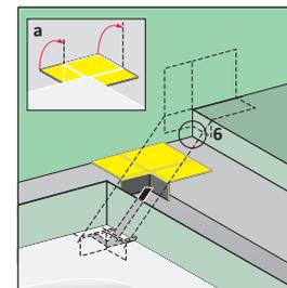
**A 28.** Flexible Dichtecke am Wannendichtband rückseitig positionieren, Dichtecke hochklappen (a) und mit dem Wannendichtband verkleben.
