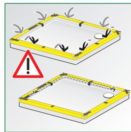
**A 21.** Das umlaufende Wannendichtband zusammen mit den Ecken um 90° umlegen und mit Klebeband fixieren. Dann umlaufend auf dem Wannerrand abschließen. Das Wannendichtband ist so vor Verschmutzung geschützt.
