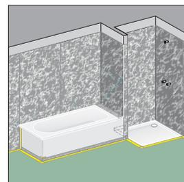
**C 14.** Fertige Dichtbahnen im Duschwannen- und Wannenbereich.
