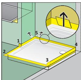
**A 25.** Nach Entfernen aller Schutzfolien an Ecke 4 und 5 wird das Wannendichtband sowie die verbliebenen Ecken 1 bis 3 an Boden und Wand mit dem Raker (Bild 23) angedrückt. Dabei von unten nach oben streichen.
