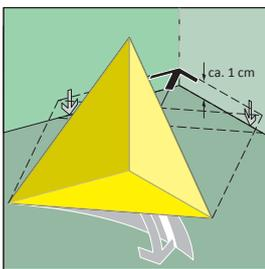
**B 4.** Pyramide in der Ecke bis ca. 1 cm über dem Boden nach unten schieben, **Abdeckfolie unten abziehen**. Die Pyramide an der Wand ganz herunter schieben und auf den Boden andrücken.
