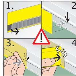
**A 8.** Die vorderseitige Schutzfolie vom grauen Wannenkleber schrittweise abziehen (1). Das Wannendichtband **exakt an die markierte Linie** am Wannenrand kleben (2). Mit dem Raket **leicht andrücken**, ggf. korrigieren (3). Mit Raket **fest an den vertikalen Wannenrand andrücken** (4)!
