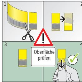
**A 3.** Prüfen der Oberfläche mit Probestreifen (1). /Entfernen der Abdeckfolie (2). Den Probestreifen auf die Wandfläche andrücken (3) und nach unten von der Wand abziehen (4), so dass der Schaum abreißt und auf der Wandfläche haften bleibt. Falls sich der Schaum von der Wandfläche ablösen lässt, muss die Oberfläche der Wand weiter behandelt werden.
