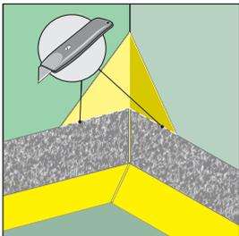
**E 7.** Überstehende Innenecke oben parallel zum Sockeldichtband mit dem Cutter abschneiden.
