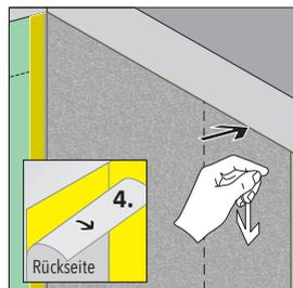
**C 7. Schutzfolie 35 cm** breit schrittweise nach unten abziehen und fortfahren wie zuvor.
