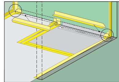
**F 6. Vorbereitung und Anbringen des Eckklebebandes:** An den Innenecken sind die Enden der jeweils drei Eckklebebands auf Gehrung anzuschärfen (siehe Bilder **B 1** und **B 8**). Die Eckklebebands dürfen sich **nicht** überlappen! (Zu große Aufbauhöhe!)
