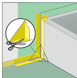
**B 11.** Beispiel: Selbstklebende **Innenecke** in der Ecke Wand/Wanne/ Boden anbringen. Ggf. kann die selbstklebende Innenecke passend geschnitten werden.
