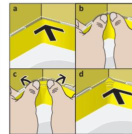
**A 23.** Nach der Positionierung der Duschwanne müssen die Ecken 4 und 5 gedehnt werden. Die Schutzfolien entfernen.
