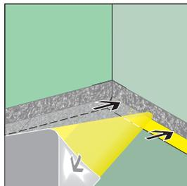
**E 8.** Schutzfolie am Beginn der Dichtbahn etwas abziehen. Dichtbahn in der Ecke beginnend auf dem vliesfreien Streifen des Sockeldichtbandes ansetzen.
