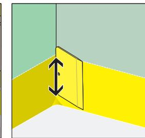
**A 24.** Mit dem Raker wird das Wannendichtband exakt in die 90°-Ecke eingedrückt.
