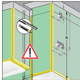
**C 3. Achtung!** Alle Dichtbahnen mit einer Zugabe von  $h + \text{ca. } 20 \text{ cm}$  abhängen! Vor dem Anbringen der Dichtbahnen ggf. die Durchgangspunkte für Armaturen etc. ermitteln und die Maße auf die Dichtbahnen übertragen, siehe hierzu Bilder D1 - D7.
