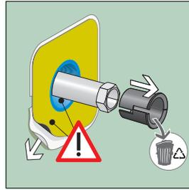
**G 13.** Einschubhülse entfernen. Dichtmanschette entfalten. Evtl. verbliebene Reste des Gleitfetts sorgfältig entfernen. Die Dichtfläche der Dichtmanschette muss absolut fettfrei bleiben! Schutzfolie entfernen.
