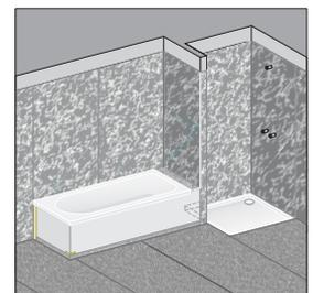
**C 15.** Fertige Dichtbahnen im Bodenbereich.
