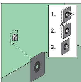
**B 14.** Alle Rohrdurchführungen (z.B. DN50) werden mit **Wandmanschetten** abgesichert: 1. Manschette mit Membrane über den Bauschutzstopfen stülpen 2. Abdeckfolie entfernen 3. Manschette blasenfrei andrücken.
