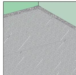
**E 10.** Dichtbahnen fortlaufend auf dem vliesfreien Randstreifen aufsetzen.
