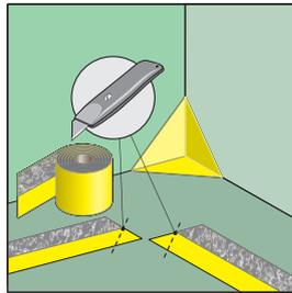
**E 4.** Sockeldichtband im Bereich der Innenecke auf 45° mit Cutter oder Schere anschrägen (Gehrung).
