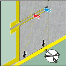
**D 6.** Dichtbahn in der Kehle des Eckklebebandes abschneiden. Dichtbahnfest anrollen.
