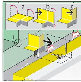
**A 18.** Flexible Dichtecke an Ecke 1 (Übergang Wand/Wand/Boden) durch Falten a und b zu c anpassen und an die angezeichnete Position an das Wannendichtband ankleben. Schutzfolie des Wannendichtbandes wieder andrücken!
