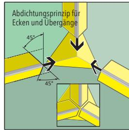
**B 1.** Die **Innenecken** (a) gewährleisten am Schnittpunkt der überlappenden Eckklebebänder (b) absolute Dichtigkeit im Bereich der verbleibenden Kehle (c). Der flexible PE-Schaum gleicht Unebenheiten im Bereich von Wand und Boden aus.
