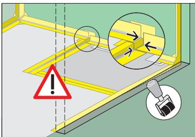
**F 7. Anbringen des Eckklebebandes am Dichtkeil:** Die Eckklebebands dürfen sich **nicht** überlappen! (Zu große Aufbauhöhe!) Alle Eckklebebands fest anrollen.
