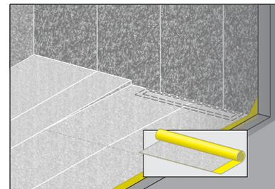
**F 9. Den gesamten Nassbereich** an Wand und Boden mit Dichtbahnen versehen.
