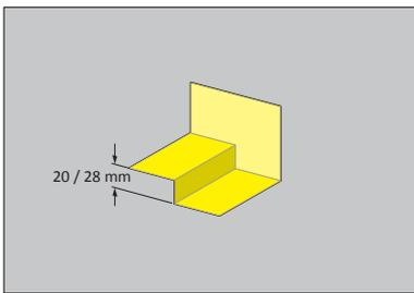
**F 1. Abdichtung Dichtkeil** (Stufe 20 oder 28 mm)
