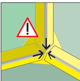
**B 9.** **Anbringen des Eckklebebandes:** An den Innenecken sind die Eckklebebänder jeweils auf **Gehung 45° anzuschragen** (siehe Bild B1). Die Eckklebebänder dürfen sich **nicht** überlappen! (Zu große Aufbauhöhe!)
