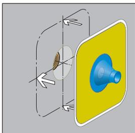
G 1. Dichtmanschette mittig zum Anschluss positionieren.
