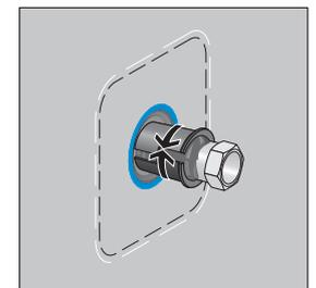
G 10. Die Dichtmanschette wird durch die Einschubhülse zusammengehalten.
