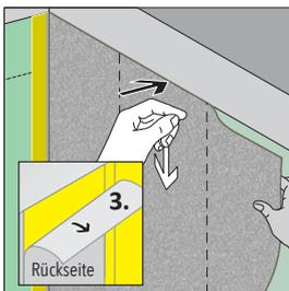
**C 6. Schutzfolie 35 cm** breit schrittweise nach unten abziehen und fortfahren wie zuvor.
