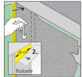
**C 5. Schutzfolie 26 cm** breit schrittweise nach unten abziehen. Den **oberen Teil** der Dichtbahn im Bereich der abgezogenen Abdeckfolie an die Wand andrücken. Restliche Schutzfolie weiter nach unten abziehen und die Dichtbahn **bis zum Eckklebeband am Boden ankleben**.
