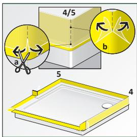
**A 20.** Die Ecken 4 und 5 müssen von unten an der Kante der Anfasslasche der Abdeckfolie ca. 10 mm nach oben eingeschnitten werden (a). Danach die Folie nach oben aufreißen (b).
