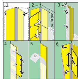
**B 7.** **Eckklebeband** falten (1). Schutzfolie links oben etwas abziehen (2). Eckklebebandhälften übereinander legen, Falz in der Raumecke oben ansetzen (3) und andrücken. Linke Eckklebebandhälfte mit Rakele andrücken (4). Rechte Schutzfolie abziehen (5) und Eckklebeband mit Rakele andrücken (6).
