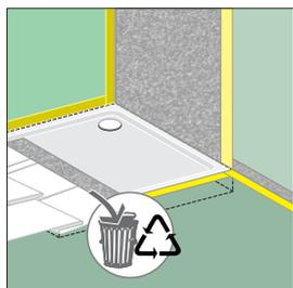
**C 12.** Die **restlichen Abdeckfolien** von der Dichtbahn **entfernen**. Dichtbahn fest am Wand- und Bodenbereich sowie am Eckklebeband andrücken.
