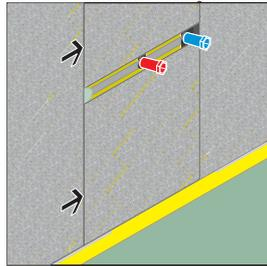
**D 8.** Die nächste Dichtbahn wird angedockt.
