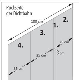
**C 1.** Schutzfolien auf der Rückseite der Dichtbahn. Reihenfolge (1.-4.), in der die Schutzfolien von der Dichtbahnrückseite abgezogen werden.
