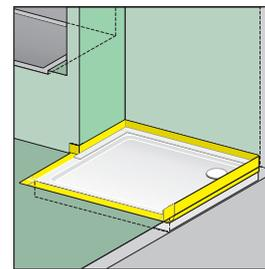
**A 22.** Die „Staubsicherung“ entfernen und das Wannendichtband kann nun mit Wand und Boden gemäß Bild 22-25 verklebt werden.
