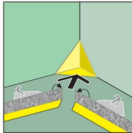
**E 5.** Rückseitige Schutzfolien ein Stück abziehen, Vliesstreifenseiten 90° zur Wand hin hochklappen und das Band in der Innenecke ansetzen.
