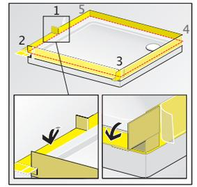
**A 19.** Die an der Ecke 1 angebundene Dichtecke umlegen und an das Dichtband andrücken.
