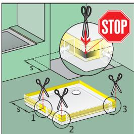
**A 11.** Das Wannendichtband bei 1 und die Ecken 2 und 3 bis **OK grauer Wannenkleber einschneiden, nicht durchschneiden!** Den Abdeckfolienstreifen des Wannendichtbandes soweit abziehen, dass die Dichtecken aufgesetzt werden können. Nach dem Aufsetzen der Dichtecken die Schutzfolien wieder andrücken!
