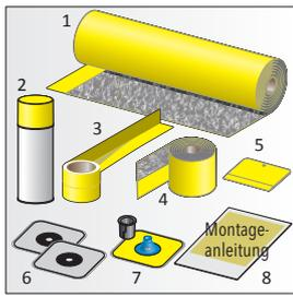
(P 5.) Selbstklebendes Wandabdichtungs-Set zur Trockenabdichtung von Wand und Boden. 1 Dichtbahn 1 m x 30 m; 2 Sprühprimer; 3 Eckklebeband 120 mm x 50 m; 4 Sockeldichtband 50 m; 5 Montagehilfe: Rakel; 6 2x Wandmanschetten 1/2"; 7 Tropfschutzmanschette; 8 Montageanleitung.
