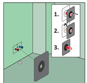
**B 13.** Alle Rohrdurchführungen (z.B. 1/2) werden mit **Wandmanschetten** abgesichert: 1. Manschette mit Membrane über den Bauschutzstopfen stülpen 2. Abdeckfolie entfernen 3. Manschette blasenfrei andrücken.
