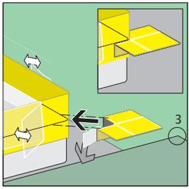
**A 15.** Flexible Dichtecke für Ecke 3 (Anbindung Wand/Boden). Schutzfolie vom Wannenkleber (schwarz) der Dichtecke abziehen, rückseitig an das Wannendichtband positionieren und andrücken. Schutzfolien des Wannendichtbandes wieder andrücken!
