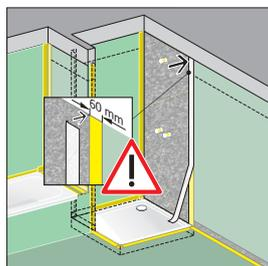
**C 13.** Auf den **vliesfreien** Randstreifen wird ein weißer Abschlussstreifen (60 mm) aufgeklebt.
