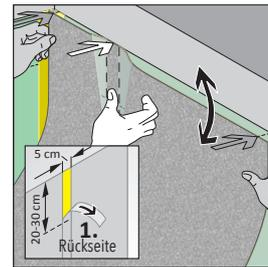
**C 4. Schutzfolie 5 cm** breit ca. 20-30 cm weit nach unten abziehen. Dichtbahn in diesem Bereich ansetzen und ausrichten. Restliche Schutzfolie schrittweise weiter nach unten abziehen und die Dichtbahn **bis zum Eckklebeband am Boden ankleben**. Details siehe Bilder C 8 ff.
