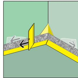
**E 6.** Restliche Schutzfolien abziehen und Sockeldichtband mit Spachtel andrücken.
