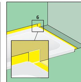
**A 29.** Alle Schutzfolien entfernen, Ecke und Wannendichtband fest andrücken.
