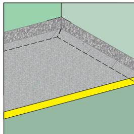
**E 9.** Restliche Schutzfolien abziehen und die Dichtbahn fest am Boden andrücken.
