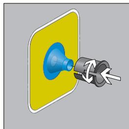
G 2. Einschubhülse etwas aufspreizen (Detail) und auf die Dichtmanschette aufsetzen.
