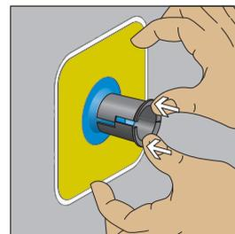
G 3. Einschubhülse mit beiden Daumen in Richtung Rohranschluss über den Fitting drücken.
