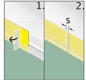
**A 9.** Beim Anfang des Wannendichtbandes ein Stück der Schutzfolie abziehen (1), dann das Ende des Wannendichtbandes auf den Anfang überlappend (s) aufkleben und **feste andrücken!** Schutzfolien wieder schließen.
