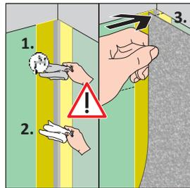
**C 2. 1.** Gelbe Überlappungszone nass abwischen. **2.** Trockenwischen. **3.** Wannenabdichtbänder, Eckklebebänder, Dichtecken und Manschetten überlappend aufkleben.
