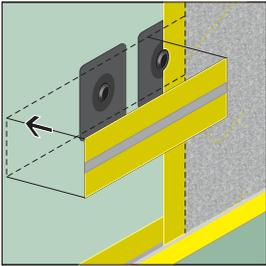
**D 1.** Einen Streifen Eckklebeband mit Kellenschutzstreifen über die Dichtmanschetten kleben. Er gewährleistet die sichere Anbindung der sich unten anschließenden restlichen Dichtbahn (D7).
