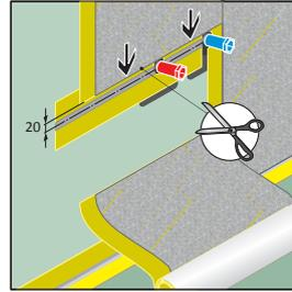
**D 4.** Von der Mitte des Eckklebebandes ausgehend die Dichtbahn **oberhalb der Rohrdurchgänge 20 mm** nach oben anzeichnen und die **Dichtbahn abschneiden**.
