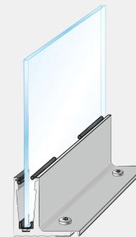
**7** Legen Sie alle 250 mm (bei jeder Bohrung) einen Klemmstab (je nach Scheibe) zwischen Profilkante und Scheibe.
