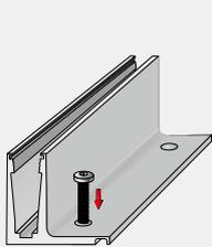
**1** Befestigen Sie das Profil. Richten Sie es an der Unterkonstruktion und nicht am Profil aus. Die Profile sind vorverformt und erst nach Einsetzen von Glas und Klemmstab im Wasser.
