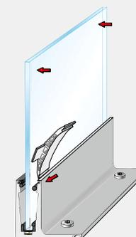
**11** Die Scheibe nach außen drücken und die Rundschnur mit dem Werkzeug in die dafür vorgesehenen Vertiefungen am Profil drücken bis die Scheibe gerade ausgerichtet ist.
