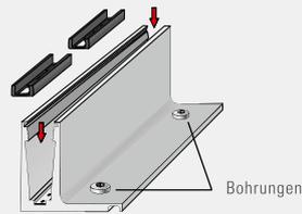
**3** Setzen Sie die Klemmschuh-Stücke alle 250 mm (bei jeder Bohrung) ein.
