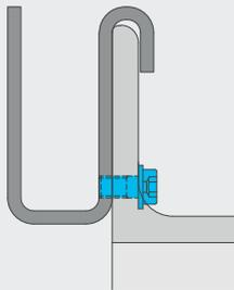
**1** BALARDO Tragprofil an Bauanschlusselement befestigen.
