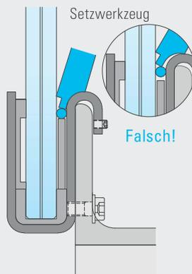
**8** POM-Stab (rund) einsetzen. Glas nach außen drücken, POM-Stab fest eindrücken und mit Setzwerkzeug auf Setzwerkzeugtiefe einschlagen. Abstand: bis 4 cm
