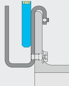
**3** BALARDO Tragprofil an der Innenseite mit Hilfe des Bauanschlusselementes ausrichten und anschließend das Bauanschlusselement an den Baukörper fest verschrauben.
