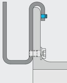
**2** Sicherungsschraube zur Lage-sicherung einschrauben.
