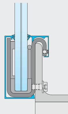
**9** Einlegebänder einkleben. Außen- und Innenblende einklippen und Dichtungen einsetzen. Fertig!
