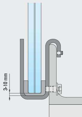
**5** Glasscheibe einsetzen. Luft zwischen Glasscheibe und BALARDO Tragprofil ca. 3-10 mm.
