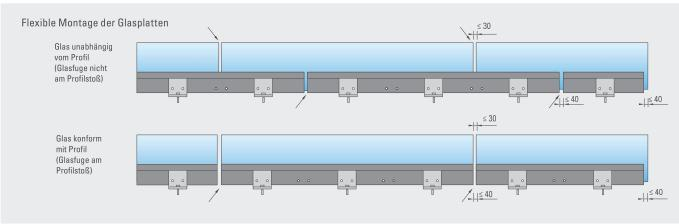
Offene, zugängliche Glaskanten sind gemäß DIN 18008-4 konstruktiv zu schützen, z.B. mit Glaskantenschutzprofil vertikal Seite 72.
