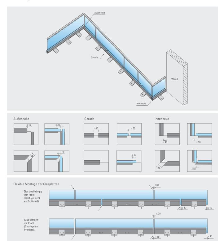
Offene, zugängliche Glaskanten sind gemäß DIN 18008-4 konstruktiv zu schützen, z.B. mit Glaskantenschutzprofil vertikal Seite 72.
