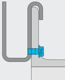
**1** BALARDO Tragprofil an Bauanschlusselement befestigen.
