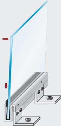
**5** Keilband außen auf der Absturzseite zwischen Tragprofil und Klemmschuh einsetzen.
