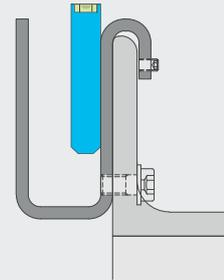
**3** BALARDO Tragprofil an der Innenseite mit Hilfe des Bauanschlusses ausrichten und anschließend das Bauanschlusselement an den Baukörper fest verschrauben.
