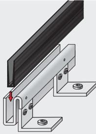
**2** Klemmschuh einsetzen (innen kurzer Schenkel / außen langer Schenkel).
