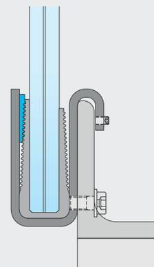
**6** Keilband zwischen Tragprofil und Klemmschuh einsetzen
