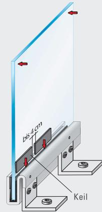
**6** Alu-Keile einsetzen. Glas nach außen drücken, Alu-Keilstücke fest eindrücken und mit dem Setzwerkzeug einschlagen. Abstand der Keile untereinander: bis 4 cm.
