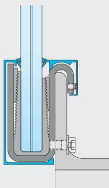
**8** Einlegebänder einkleben. Außen- und Innenblende einklipsen und Dichtungen einsetzen. Fertig!
