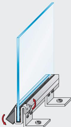
**7** Einlegebänder einkleben. Außen- und Innenblende einklipsen und Dichtungen einsetzen.
