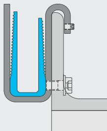
**4** EPDM-Klemmschuh einsetzen (innen kurzer Schenkel / außen langer Schenkel).
