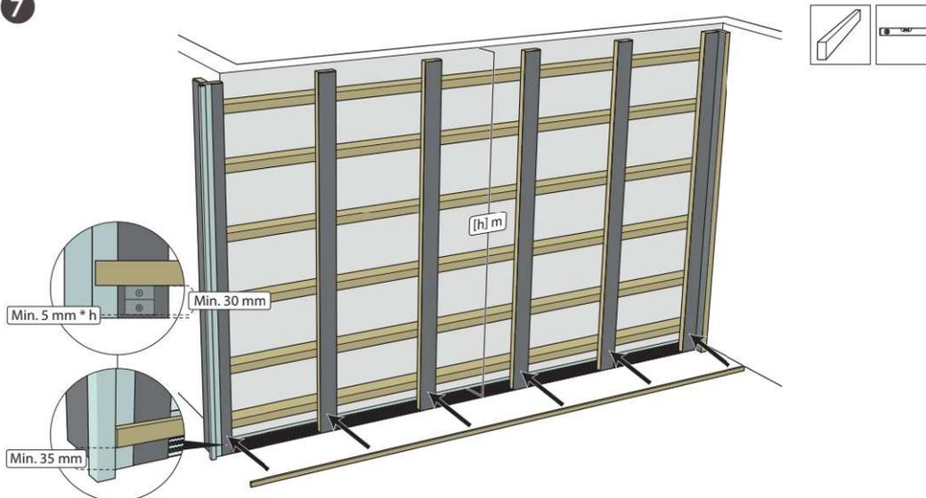
Montieren Sie eine Wasserwaage oder Montageleiste mit Schraubzwingen in mindestens 35 mm Höhe an den vertikalen Lattung. Sie können auch mit einem Baulaser eine Linie projizieren.
