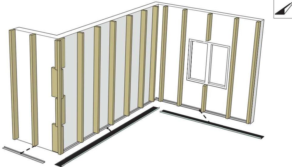
Stellen Sie sicher, dass die vertikale Lattung installiert ist. Montieren Sie dann die Lüftungsgitter an der Unterseite und bei einer Unterbrechung der Fassade. Die Lüftungsgitter sollen mit einem freien Luftdurchlass von mindestens  $200 \text{ cm}^2$  pro  $\text{m}^1$  montiert werden.
