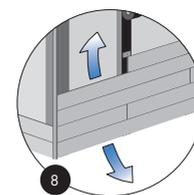
Das System enthält einen Belüftungsabstand zwischen dem tragenden Mauerwerk und den Paneelen und vermeidet so Hitzestau und Feuchtigkeitsbildung.
