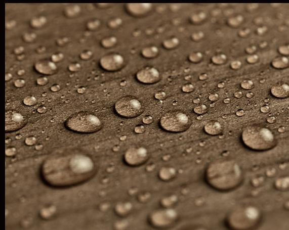
Die geschlossene Oberfläche ist das Ergebnis der von Trespa entwickelten Elektronenstrahl-Härtung (EBC). Nur so ist das Material in der Lage, den Schmutz abzuweisen, Abblöschungseffekte zu vermeiden und zugleich die Farben zu schützen.
