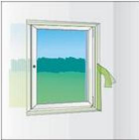
Bild 4: Nach Befestigung der Kammerleiste am Rahmen Aktivierung von TP001 illmod i durch Abtrennung der überstehenden Folie.
