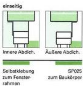
Bild 13: E = einseitig: ein Selbstklebestreifen befindet sich als Selbstklebung zum Fensterrahmen auf der glatten, unbedruckten und dämmstoffseitigen Folienseite.
