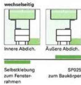
Bild 14: W = wechselseitig: ein Selbstklebestreifen zum Fensterrahmen befindet sich auf der überputzbaren, bedruckten und sichtbaren Folienseite.
