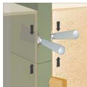
Bild 2: Stumpfstoß im Massivbau
