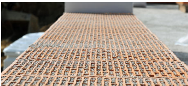
Vollständig verfüllter Hohlziegel
